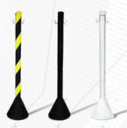
Pedestais para apoio de correntes. Confeccionado com altura de 90 cm, base plástica cônica em polietileno (PE) com 21 cm, com enchimento em concreto e tubo de PVC com diâmetro 1 1/2", com peso aproximado de 5,5 Kg.
