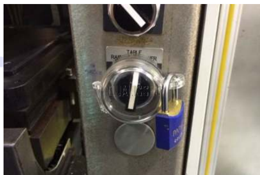
Bloqueio de chave seletora
