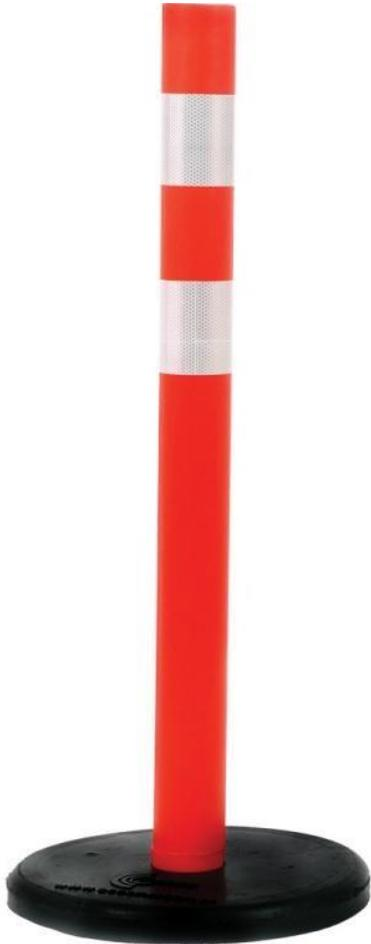
**Descrição:** Fabricado em polietileno semi-flexível, com duas faixas refletivas, proporciona uma sinalização com eficiência e segurança. O Balizador Tubular é utilizado na sinalização de obras rodoviárias ou urbanas, onde se faz necessário a divisão da pista dupla em única. Sua estabilidade é gerada pela concentração do peso em sua base, devido o acoplamento de uma base de borracha reciclada.
