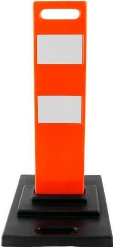
**Descrição:** Produzido em polietileno semi-flexível com duas faixas refletivas em cada lado, o Balizador Tipo Viga é utilizado no início das obras, em rodovias e na divisão de pista única em pista dupla. Seu peso é concentrado na base através do acoplamento de base oca fabricada em polietileno cor preta, que preenchida com areia mais do que duplica seu peso original.
